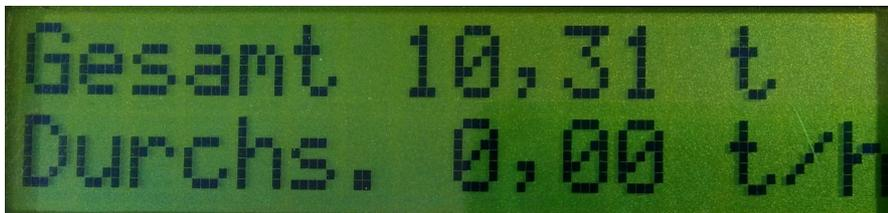
Es wird das zuletzt erzeugte Gesamtgewicht und der aktuelle Durchsatz angezeigt. Durch Drücken der blauen [Null] Taste kann jederzeit das Gesamtgewicht auf Null gesetzt werden.
